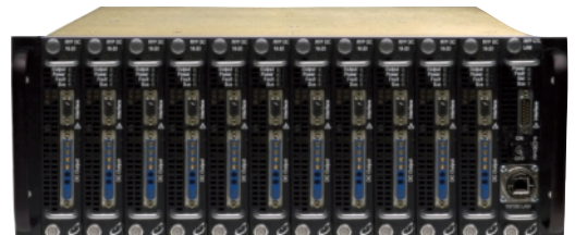
Bild 3: Platzbedarf: 12-kanalige lineare Stromversorgung (1000 W gesamt) und 12-kanaliges Schaltnetzteil mit 4 000 W.
