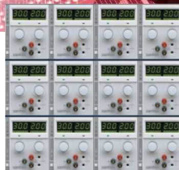
Bild 3: Platzbedarf: 12-kanalige lineare Stromversorgung (1000 W gesamt) und 12-kanaliges Schaltnetzteil mit 4 000 W.
